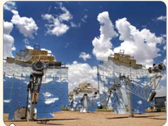
Zonnepanelen met reactoren (Sandia)
